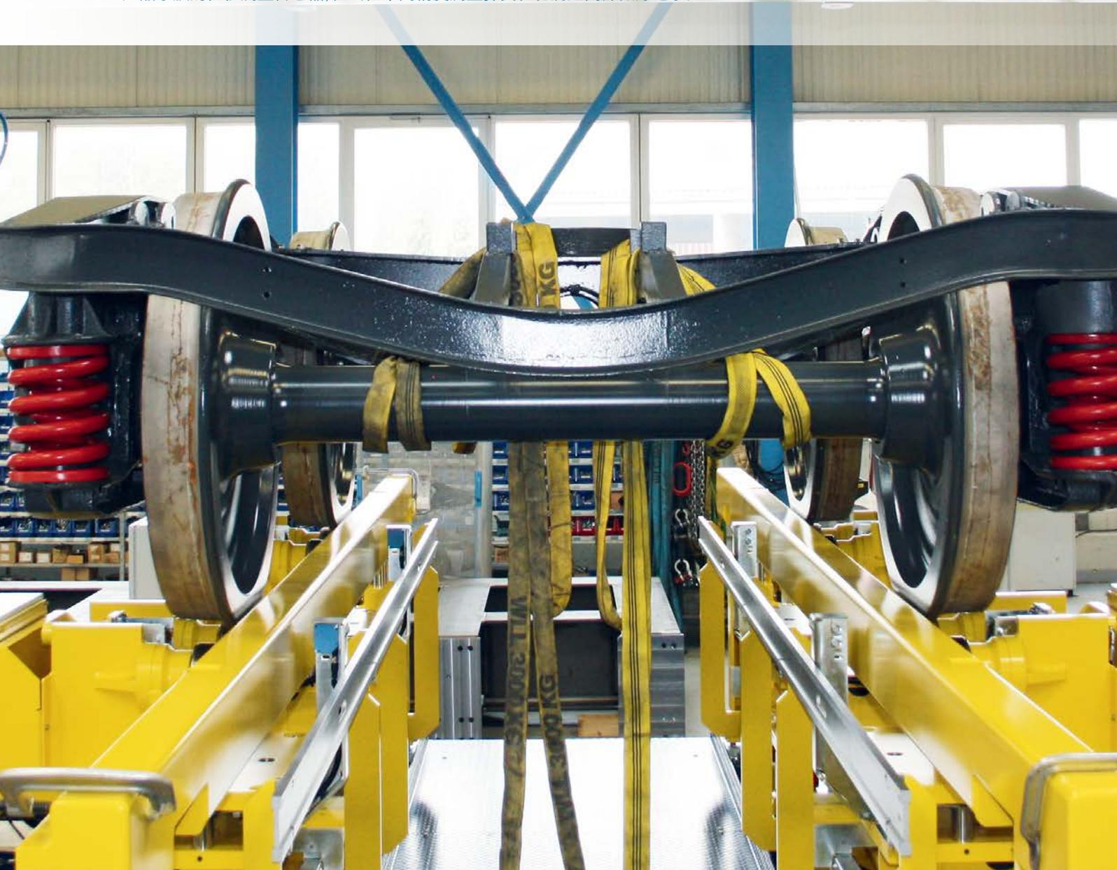
>> 基于其高分辨率,位移测量传感器 OD Value 与 OD Mini 和带有 EtherCAT® 接口的拉线编码器 BTF08 可以几分之一毫米的精度采集距离、行程和位置。但 EtherCAT® 编码器的特殊优点在于其能够完美集成到转向架试验台的 Beckhoff 控制系统内。由此 Nencki 不仅省去了额外的布线工作,还赢得了全面的诊断选项——这是许多客户所看重的。
