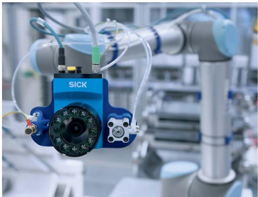
可编程 2D 相机 InspectorP65x 主动控制机器人手臂。
