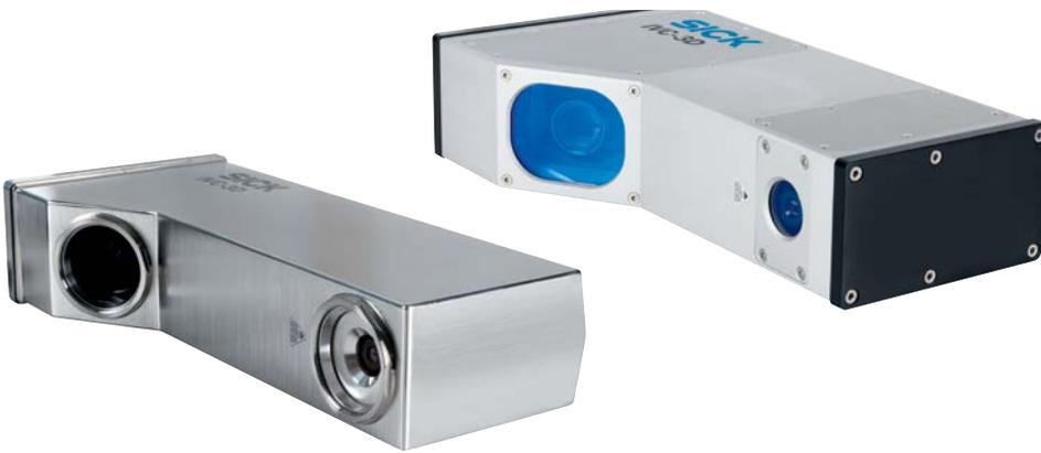
>> 系统由 ABB(能源与自动化技术领域的一家全球领先集团)的自动化机器人、一个控制面板、一个用于精确测量宽度的传感器及四个 SICK 的 3D 视觉传感器 IVC-3D。它们具有 0.2 mm 的光学分辨率,也适合在工业环境中的严苛条件下进行测量。3D 视觉传感器运用激光三角测量法的工作原理。集成在传感器外壳内的线激光束将一道光轨投射到物体上,从而采集物体的轮廓。因此,IVC-3D 能够从这些轮廓中准确创建镁砖的 3D 图像,发现体积错误并极其精确地测量。这样砖的质量在制造流程中就能得到检查,并且有缺陷的物体可以被及时剔除。
