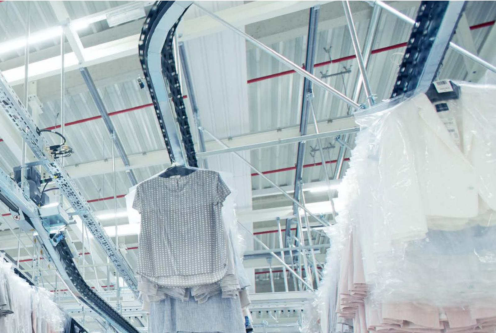
GERRY WEBER 采用 SICK 的 RFID 系统实现单件服装的全自动拣货和识别。用于挂装服装的 RFID 门式系统 RF-GOH 和 RFID 隧道式系统 RFMS Pro 与输送设备制造商共同设计而成，并集成到 GERRY WEBER 的新物流中心内。其他人工拣货位配备了 SICK 的 RFID。
