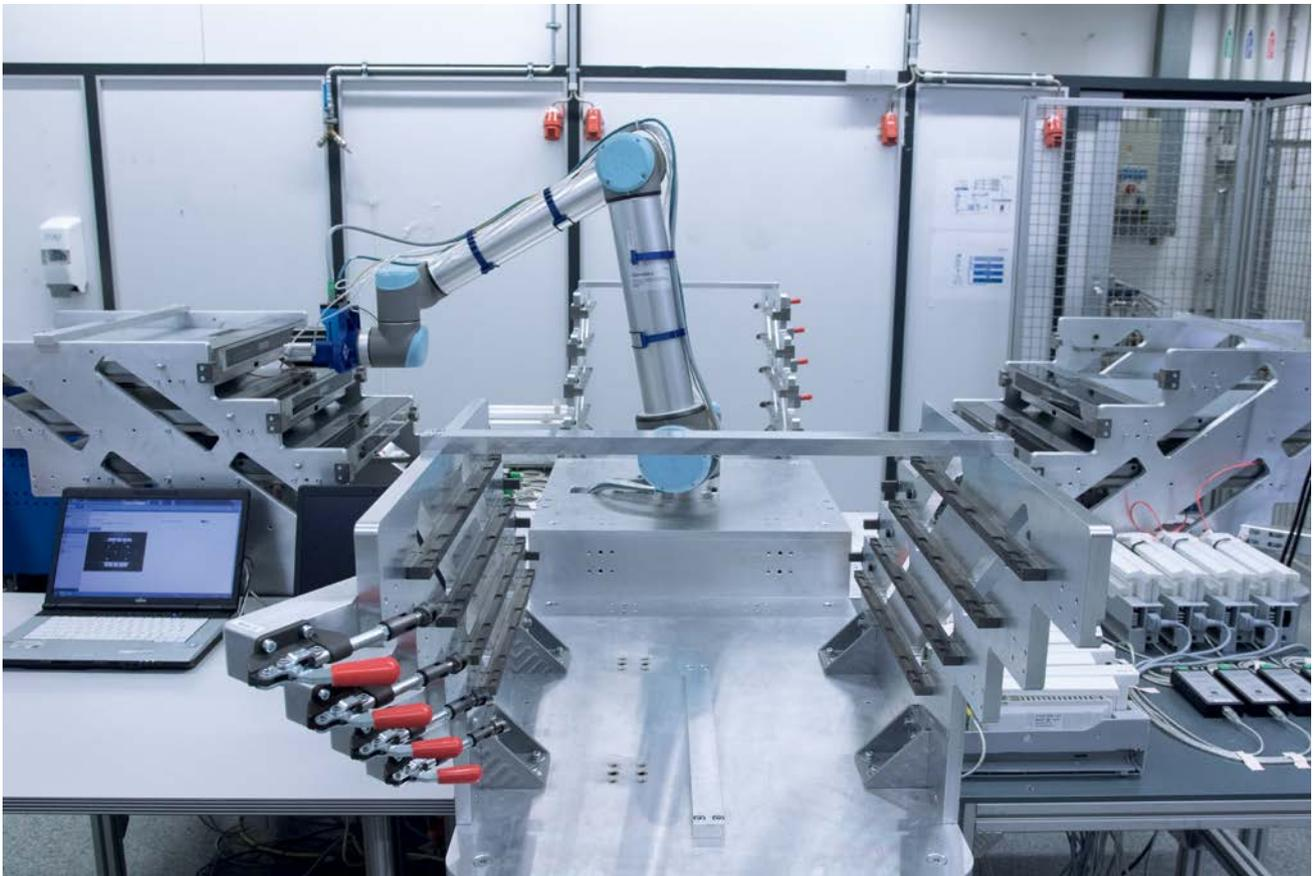
洗碗机面板使用寿命试验的实验室:移动式机器人系统负责整个测试循环。
