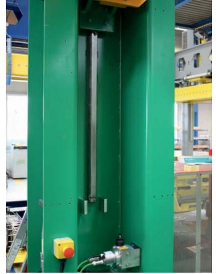
所有轨道上的安全行驶——Nencki 通过 SICK 的位移测量传感器和 Ether-CAT® 拉线编码器正确拨调了道岔。(tm)
