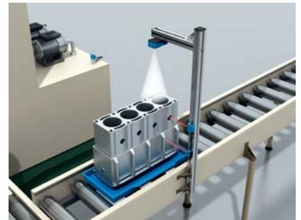
是否所有钻孔和缺口都存在并正确完成?为了在加工完每一个发动机缸体后进行 100 % 质量管理,视觉传感器 Inspector 不仅检查是否存在,还检查轮廓或钻孔的形状是否正确。未正确加工的零件将在进一步加工前被剔除。可以及时暂停生产流程,以便例如更换损坏的工具。另外,传感器还能根据示教特征识别单个零件。这些信息被传递至下游机器的控制系统,生产流程可在必要时相应转换。
