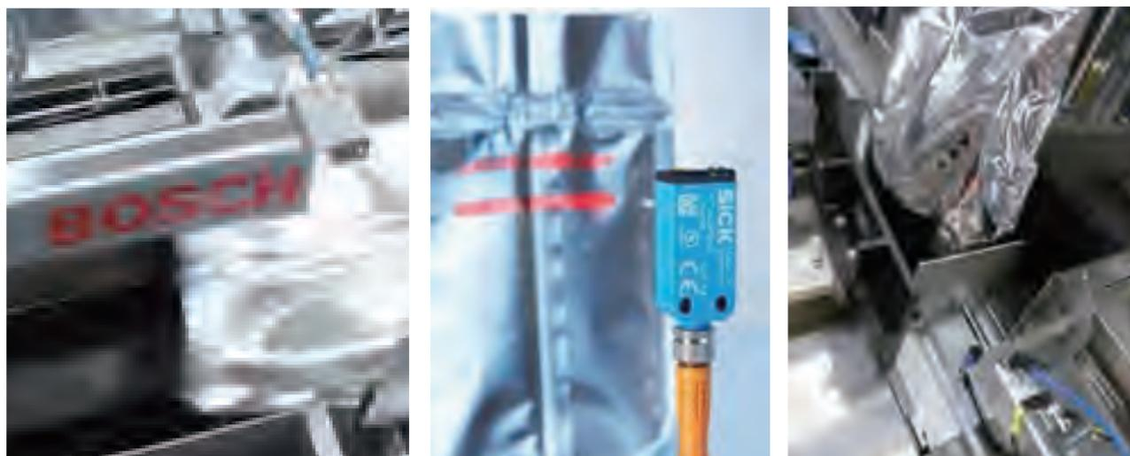
检测一定大小开孔的物体，当被检测物体被两条线光源同时覆盖时开始输出信号，此时任意一条线光源掉入缝隙或者其光线没有被反射回来，均不影响稳定检测，直到物体离开传感器的检测范围。
