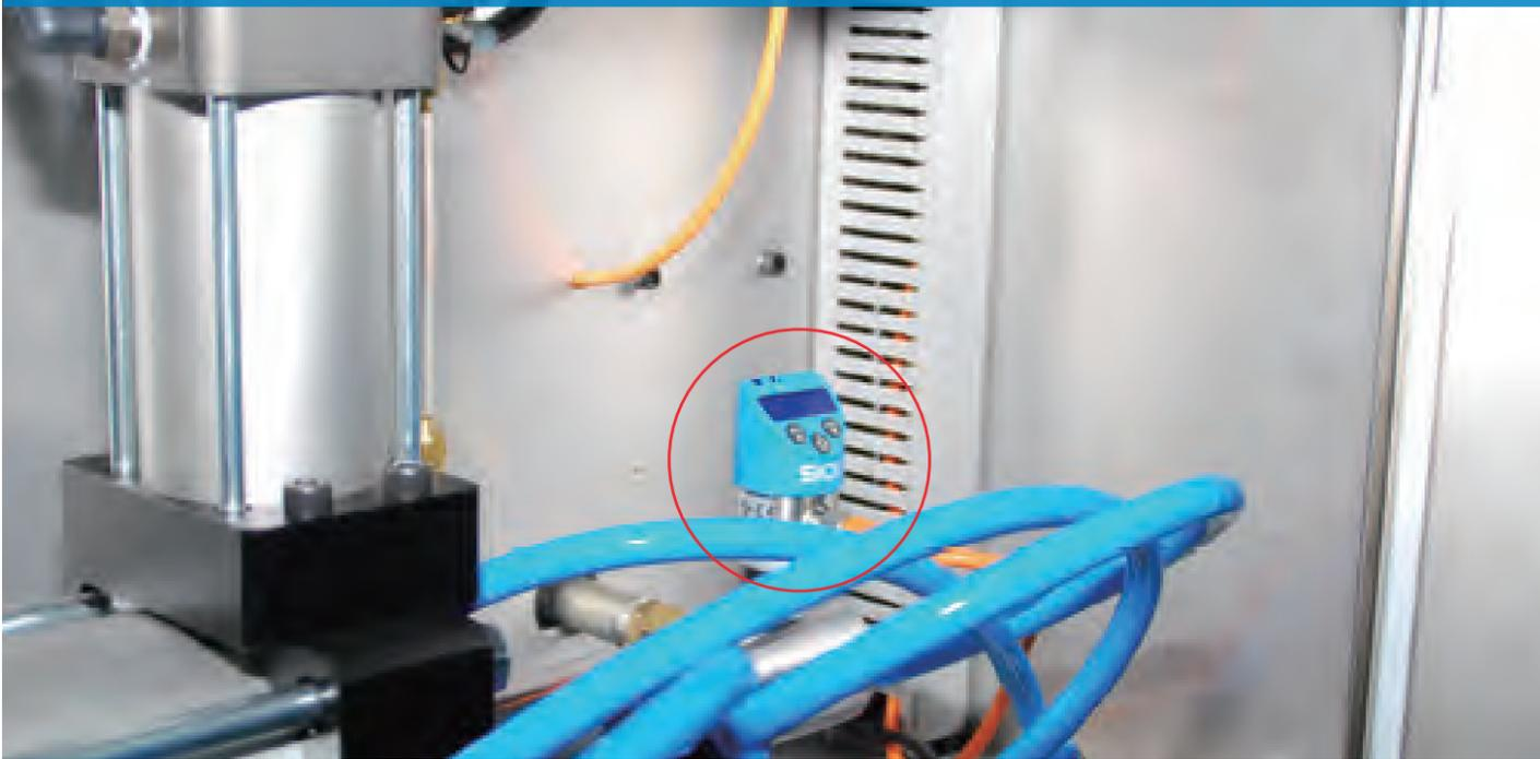
在运动控制的应用中，气动装置最重要的控制参数之一就是驱动空气的压力稳定，以往只能透过机械式的压力开关及泄压阀的组合应用来达到保护气动装置的妥善机制。来自 SICK 的 PBS 电子式压力开关，可应用于监控液体、气体在不同压力范围内的压力状态，提供全方位的解决方案，不仅可任意设置高低压力开关值输出，全幅的类比模拟量输出，更可在显示屏幕上自由切换多种压力值的单位，并且安装调试简单，传感器上下两端可旋转约 320 度，为客户提供在压力监控应用中所有可能需要的功能。
