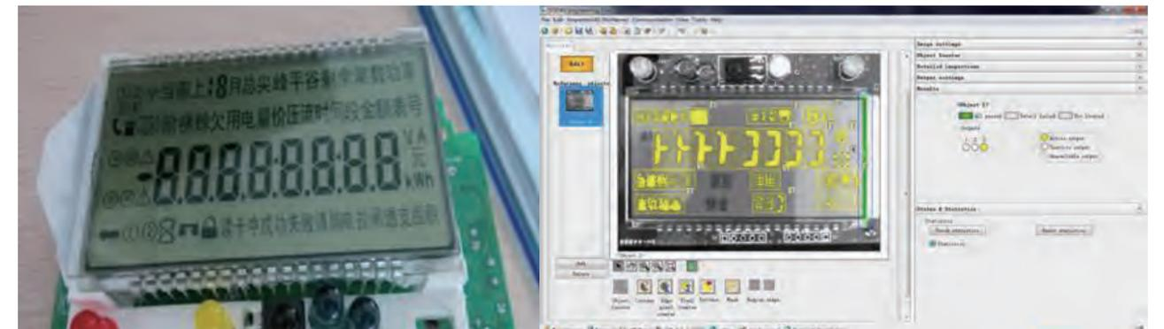
相比，或多或少都会有些偏移。如果不使用目标定位器，被检测字符的位置和像素计算工具的监测区域不能匹配，会造成误检和漏检，影响检测结果的可靠性。使用定位器后，检测区域将不再受电表位置的影响。
