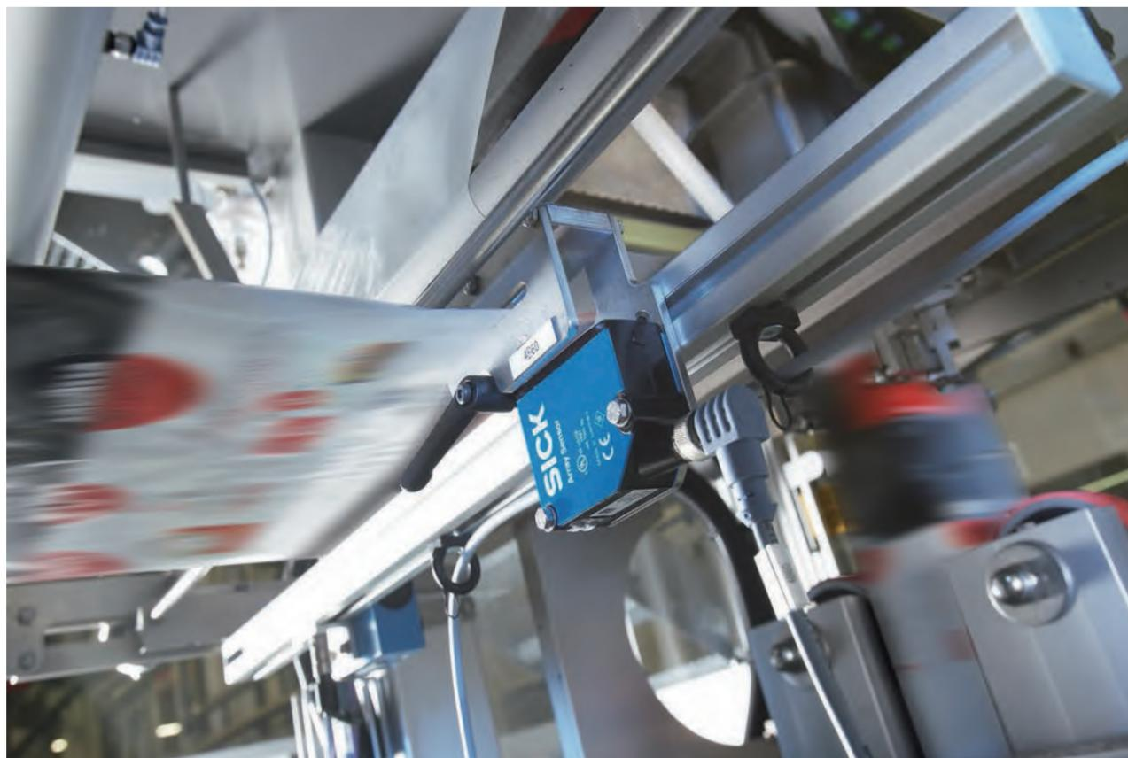
采用模块化的设计，德国博世 (Bosch) 的 PME 封装机适应市场多种需求。通过使用 SICK 光电传感器，色标传感器以及线光源传感器，博世生产出的机械兼具灵活性同时产能进一步提升。
