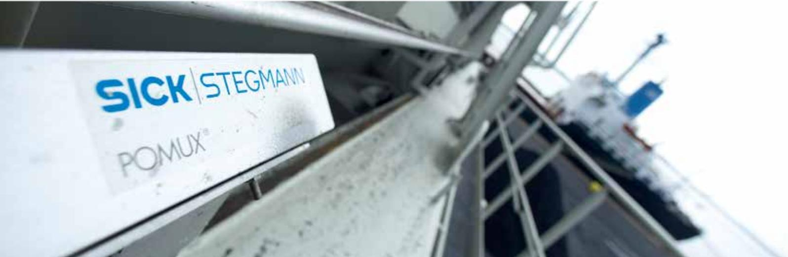
>> 天车定位可以采用包括“激光距离传感器”和非接触的“磁式线性编码器”等检测方式两种检测方式采用的都是非接触式的检测原理，但激光检测采用的是光电的检测原理，对环境光线和现场环境有更高要求，而且激光测距普遍只能应用与室内，在室外的运用存在一定的局限性。此外，工程施工安装线性编码器较激光测距有较大的优势，激光测距安装起来比较复杂，在应用方面，如果在一跨中（X方向）存在多个行车，只需安装一个阅读器，感应标尺只需根据实际测量距离增加尺寸。针对不同的应用，SICK公司生产的KH53磁性检测原理的编码器，非常适用于恶劣环境的使用，产品有增强型和标准型两种类型来应对客户的不同需求。
