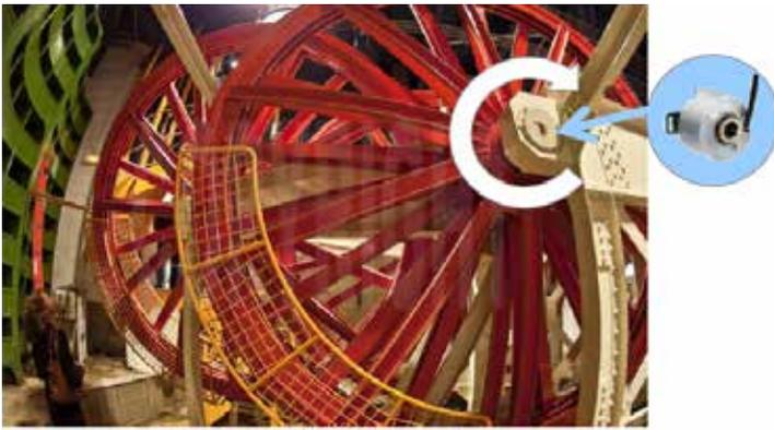
滑轮的位置，则是由一个配备有抗震性能极佳的金属码盘的旋转编码器 DFS60B-BEPC10000 控制滑轮的转速。同样的，对面位置还安装了一个相同的旋转编码器作为备用。
