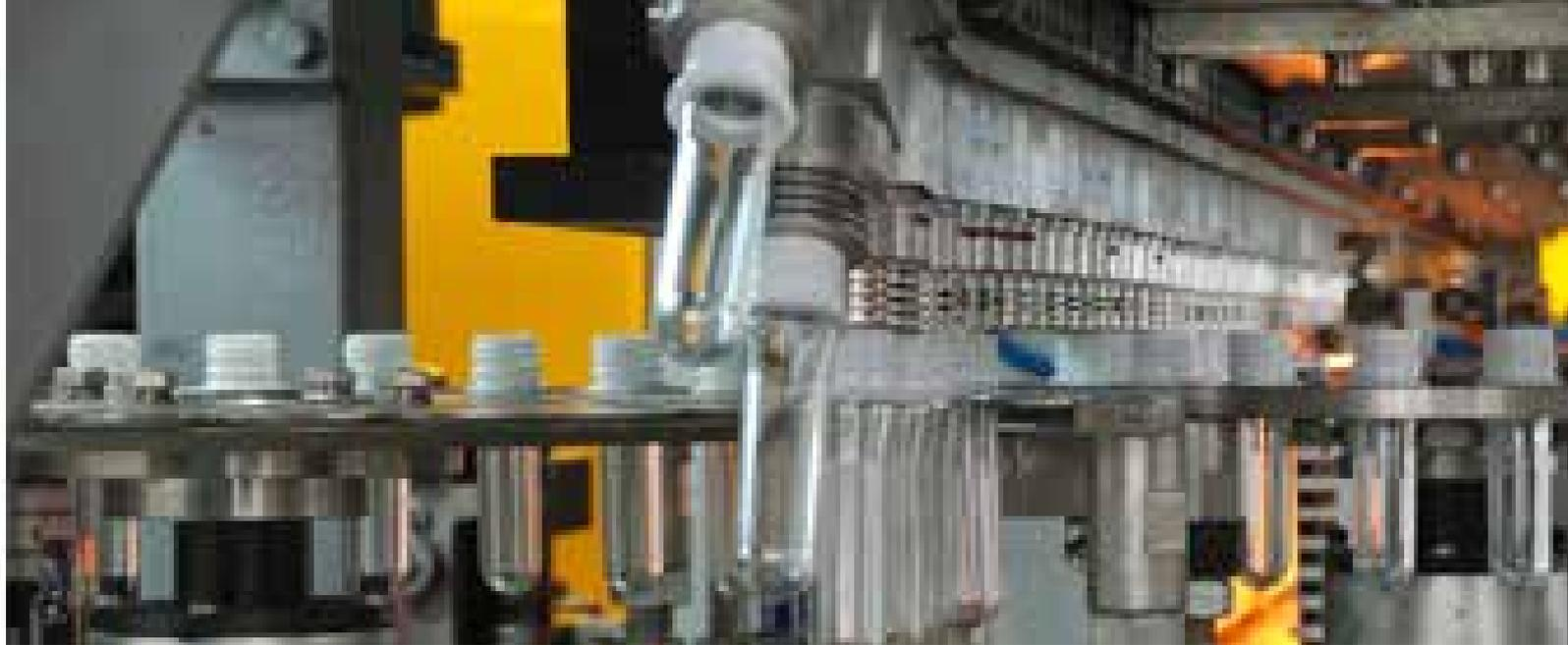
拉伸气缸动作令胚模膨胀；5) 高压吹气，瓶胚依模具定型，并保压一定时间；6) 将已成型瓶中的高压释放，气缸复位——取瓶。
