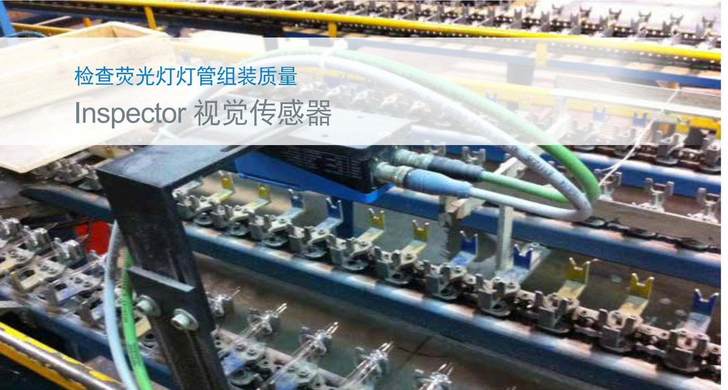
在荧光灯灯管组装生产线上，有众多工位需要人工检查每一工序的组装质量：端口，灯丝，涂层，粘合剂等等；应用 SICK Inspector 视觉传感器轻松解决每一项检查任务
