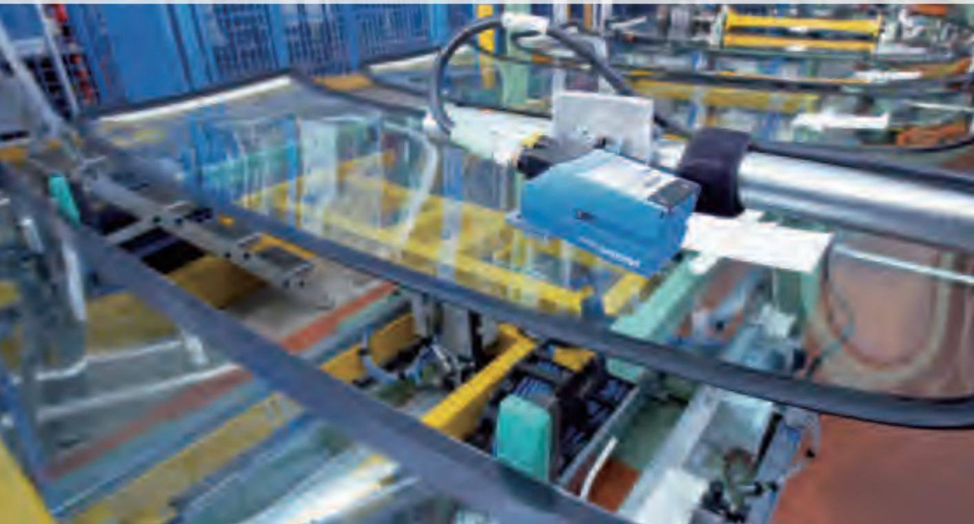
全球最大的卡车组装工厂 Daimler 公司位在德国东南方的 Wörth 市。其生产商用车的速度非常快，平均每三分钟就有一辆卡车从生产在线产出，每天约有 470 辆的卡车组装完成并从组装厂中驶离。这些卡车总共约有六种不同的系列，并且有 70,000 多种不同的组件选项需要组装，在挡风玻璃组装流程中，SICK Lector620 条码阅读器负责识别在挡风玻璃上的条形码的重要任务。
