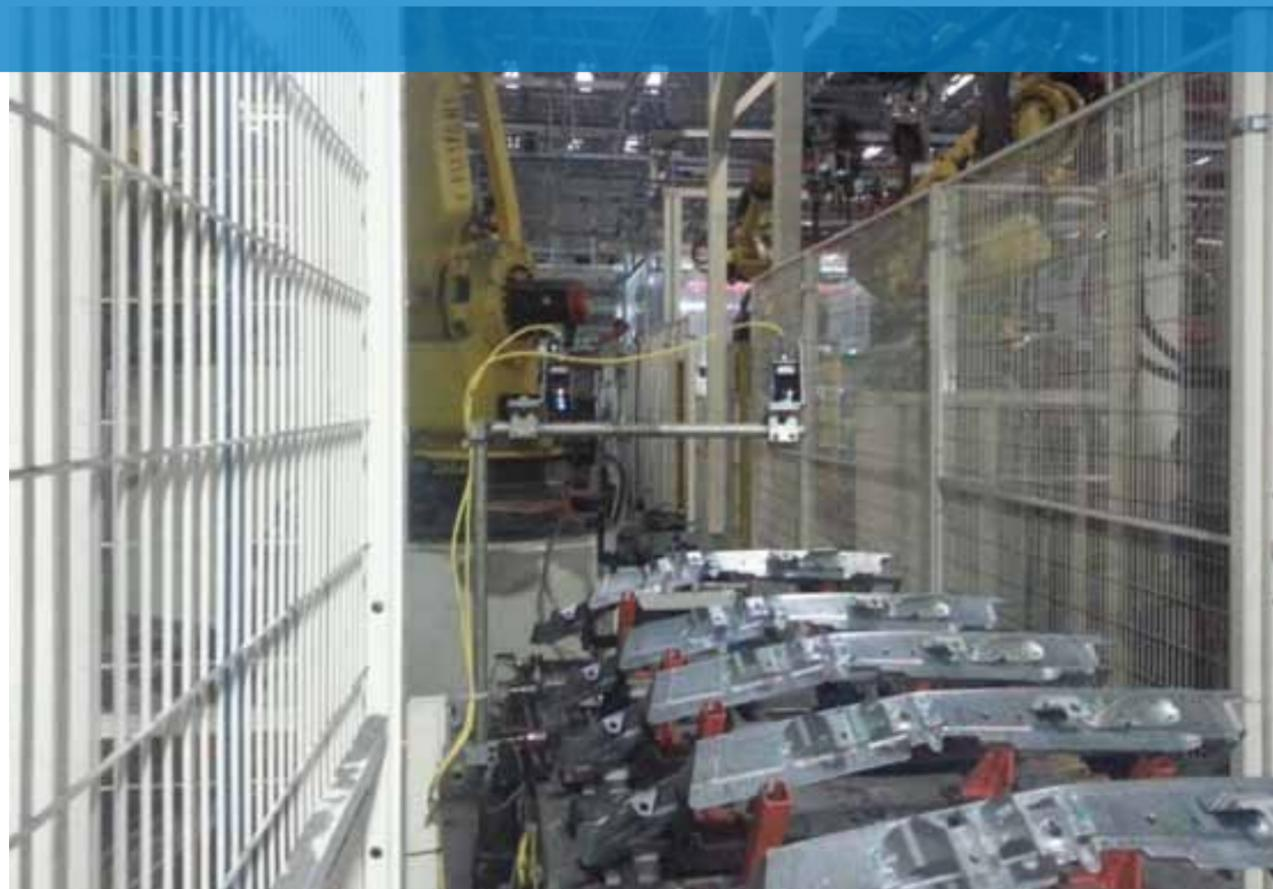
在汽车的生产 and 装配过程中，有诸多工艺涉及到中量程激光测距的应用。我们今天介绍的是 DS50 激光测距传感器在白车身焊接中的应用。
