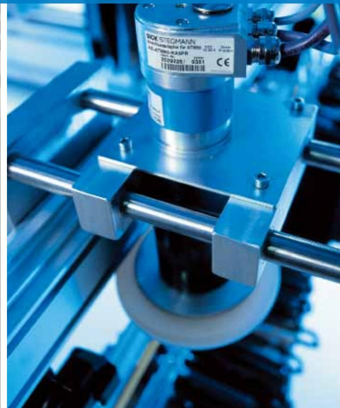
合的技术，位置检测精确和可靠。这不仅是因为其 13 位（单圈）X13 位（圈数）位的极高的检测精度，更得益于其允许的轴负载能力分别高达径向 300 牛和轴向 50 牛，其抗冲击性和抗振动性分别高达 100g（根据 EN 60068-2-27）和 20g，10 赫兹 ... 2000 赫兹（根据 EN 60068-2-6）。
