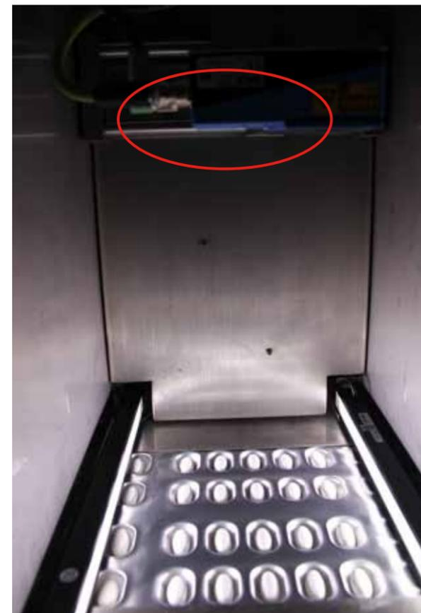
内置的 LED 光源，需要使用外部条形光源，低安装角度。I40 拥有灵活的设计理念（可更换镜头、光源，并且可扩展 I/O）和功能强大的软件功能，客户对在高速泡罩包装机中 100% 检测药片质量的效果非常满意！
