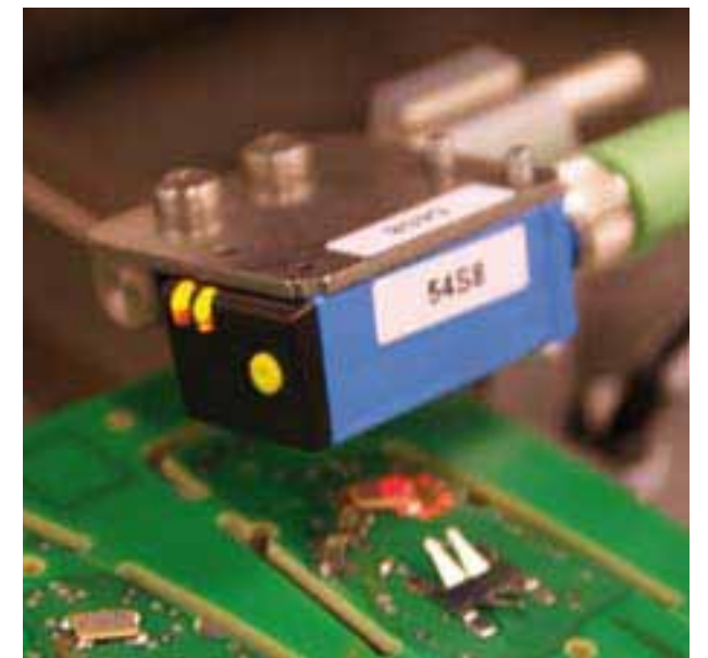
SICK 的线光源型 W4 为带孔 PCB 提供可靠稳定的检测方案
