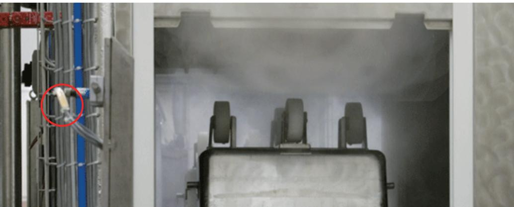
在食品加工运送载具的洗涤系统中，SICK 传感器发挥其弹性化的检测能力；高工业防护等级的不锈钢圆柱型光电传感器提供最佳的检测能力并提升设备的效能。
