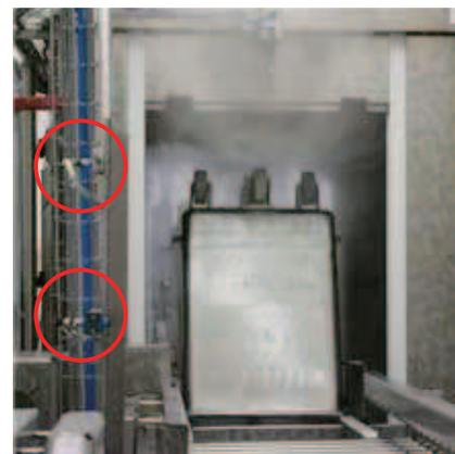
的测试。SICK 的光电传感器最终确实证明了可以满足 Daloon 公司所提出的这些严峻环境下的特殊规范与要求；包括工业保护等级需达 IP69K，以及提供确实可靠的运输载具位置点的感测结果。圆柱型光电传感器还可以被整合安装在洗涤系统中。这样可以确保运作无故障、以及零风险的洗涤设备或运输载具故障。它们负责检测运输载具是否正确抵达定位点，正确到达定位的载具才可以开始进行洗涤任务。若控制器未接收到传感器发出的正确信号，在洗涤任务开始前，载具还必须还必须重新定位直至抵达正确位置为止。
