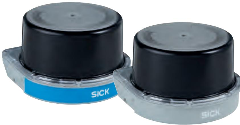
MRS1000的优势可不仅仅是提供了更多的功能。这种3D LiDAR传感器（亦称为3D激光扫描仪）利用集成区域监控功能，可同时进行四层检测。该产品适合各种应用，并有助于降低存储成本，减少购买不同型号产品的额外花费，且丝毫不会影响测量精度。其配备先进的HDDM+技术，可同时处理三个回波信号，持续保证稳定和精确的测量结果，而且即使是在严苛环境条件下，也能提供多达每秒165,000个测量点输出。该设备封装在一个IP67防护等级的外壳内，可靠性非常高，同时扩展了在“室外”环境下的性能范围，因此显著提升了应用的灵活性。
