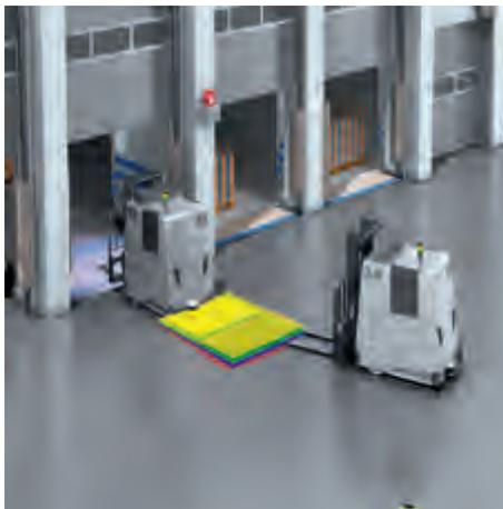
MRS1000为自动驾驶车辆系统的移动危险区域防护提供了一种地面基准评估 (GRE) 功能。使用该功能，传感器可区分并检测路径（货盘或小型装载机）上的物体以及地面上的台阶和坑洼。通过调节LiDAR传感器的灵敏度，还能设置待检测物体的高度。此外，MRS1000的四个扫描平面还可以检测伸入路径的物体。通过这样的方式，MRS1000就能帮助车辆在可用空间时避免发生碰撞、检测货盘缺口并为AGVS提供支持。
