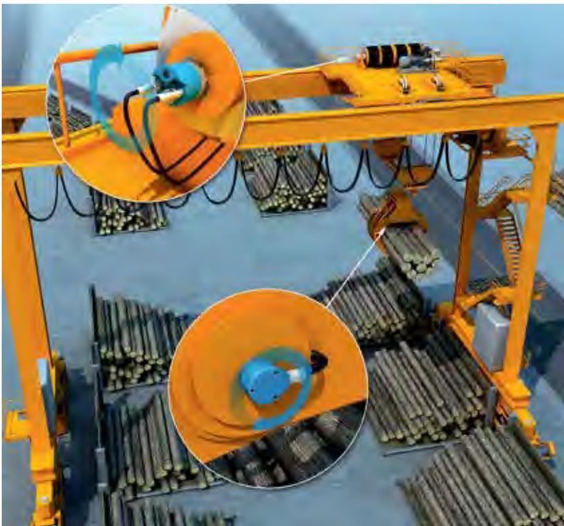
使用起重机移动和装载货物时，您必须检测夹钳高度。此时，安装在测量鼓上的绝对值型编码器正是理想之选。您还可以在夹钳上额外安装一个绝对值型编码器，计算夹钳的打开角度。
