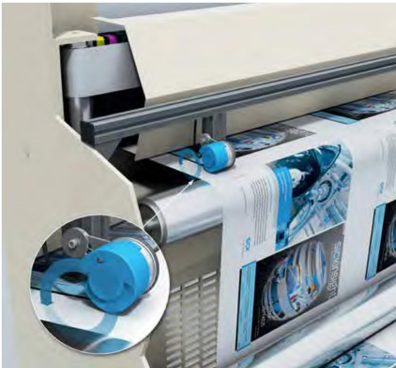
增量型编码器检测印刷机的速度，提供准确的位置信息，确保将图案清晰地印刷在正确的位置上。无论您需要印刷清晰易读的条码，还是高分辨率要求的检验卡、礼品卡或手册，该编码器均可通过精确的速度监控帮助您实现最佳的印刷质量。
