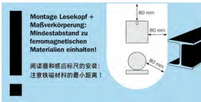
不允许在阅读器的安装表面使用铁磁材料。
