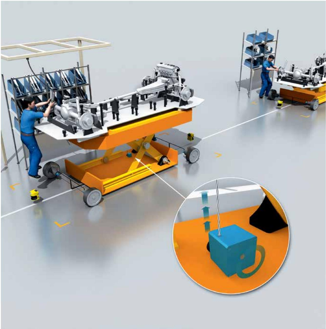
汽车装配时，制造商通常需使用剪式升降机，因此操作人员必须确保升降机位于理想的工作高度。
