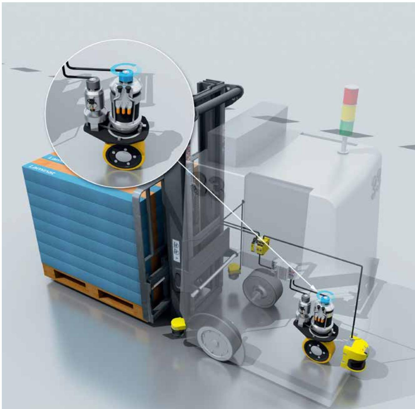
增量型编码器通过检测电机速度确定车辆速度，既可以安装在电机上（参见图片），也可以安装在车桥或旋转轮上。
