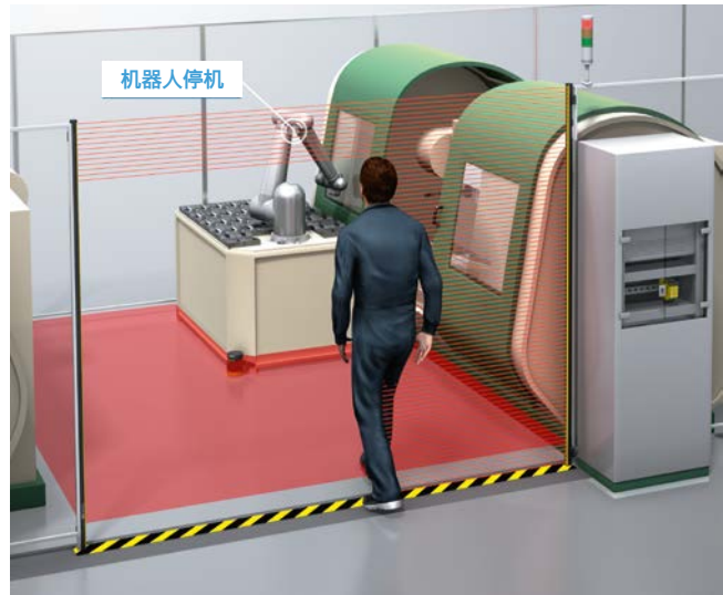
2 当操作人员中断主要防护设备的光束时,机器人停止。
