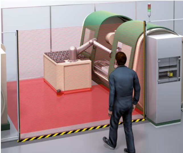
1 sBot Stop 以两种防护设备而出众:安全光幕或多光束安全光栅充当用于进出控制的主要防护设备,安全激光扫描仪充当用于存在性检测的次要防护设备。
