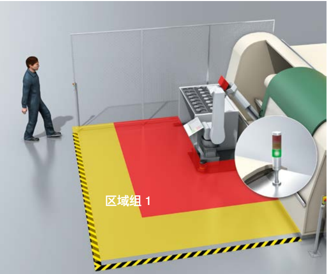
1 sBot Speed 中的安全激光扫描仪利用两个不同区域组, 各由一个警告区域 (黄色区域) 和一个保护区域 (红色区域) 组成。每个保护区域的最小距离必须基于机器人速度来定义。
