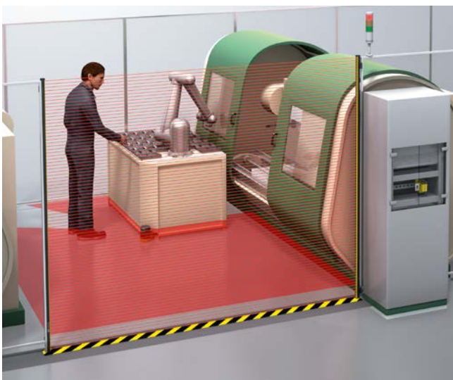
3 次要防护设备可识别人员是否位于保护区域,由此确保当操作人员在危险区域逗留期间,机器人安全地保持停止。
