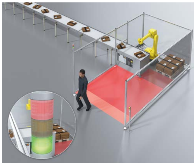
4 一旦人员离开保护区域 1,机器人在安全序列监控检查成功后自动重启。只有当人员未正确遵循预期的退出序列或进入保护区域 3 时,才需要手动重启机器人。
